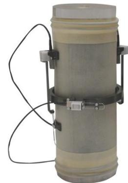
**LVDT** : déplacement d'un noyau ferromagnétique dans une bobine. Plus robustes mais plus lourds, ils permettent une utilisation sous de fortes pressions et températures.
